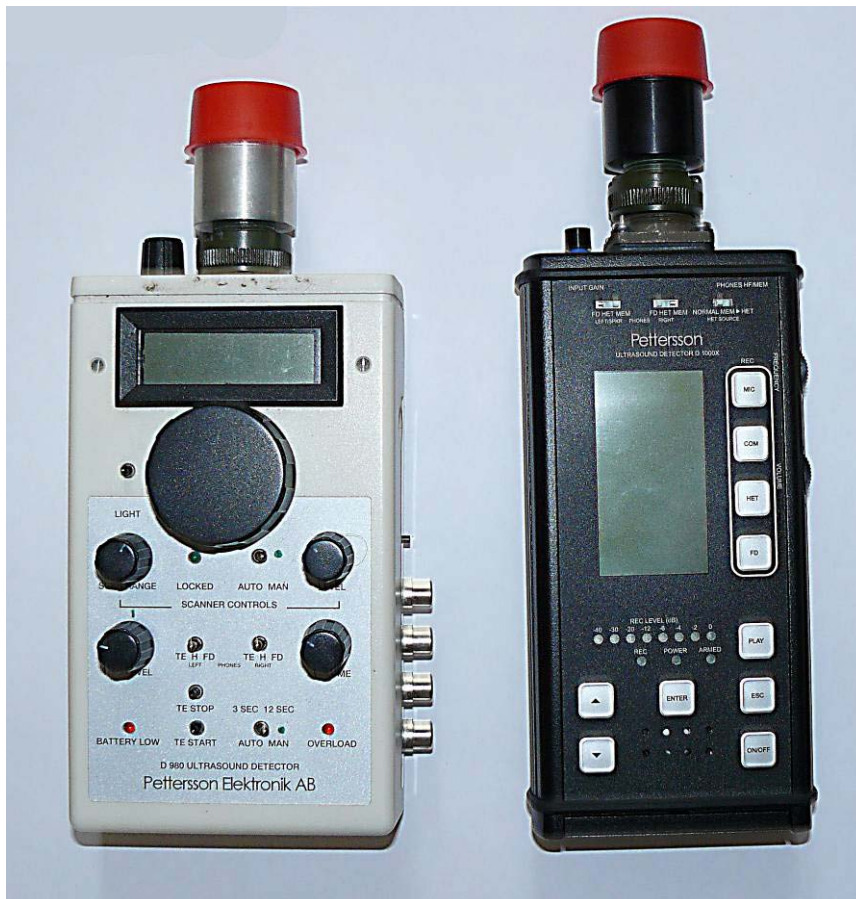
Détecteurs à ultra-sons, modèles D980 (à gauche) et D1000X (à droite) « Petterson elektronik » Photo : Cédric LOUVET
