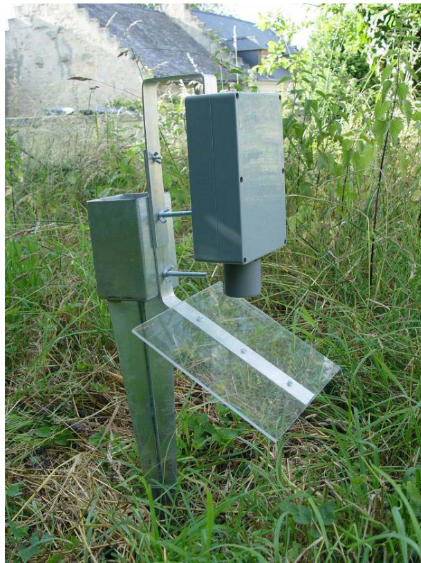
Station fixe d'enregistrement automatique des signaux de chiroptères avec système ANABAT Photo : Cédric LOUVET
